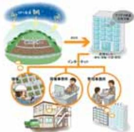
地滑り、斜面崩壊、地盤沈下、土石流検知や構造物の変位等を遠隔監視するシステムです。WEBでデータの閲覧が可能ですのでインターネット環境が整っていればどこでもその挙動が監視出来ます。現場状況に応じた通信回線網の選択が可能であり、災害時に強い無線通信インフラも完備。機器類はヘルスチェック機能を有しているため、データ欠損が予防されるとともに、各々のセンサーデータに対し、管理基準値を設定すれば、お客様に警報メール・音声での通報が可能となります。
