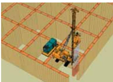
**地盤を格子状に地盤改良し液状化を防止するTOFT工法は東日本大震災においても効果が確認され、浦安などの宅地の対策にも期待される工法**
