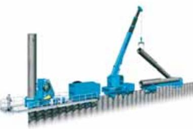
**無駄な仮設工事が不要で、杭連続壁を最小の工程で急速に構築**
