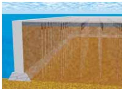
**静的圧入方式によるドレーン打設で振動・騒音・地盤変位が少ないため、
