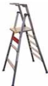
広い天板（550mm×400mm）によって作業姿勢が安定し、壁際に近い作業が可能。作業床端部を作業者に伝える円弧状の墜落予防の内蔵式感知ガードを装備。手挟み防止の減速装置や70mmの超ワイドな踏み床幅により強度もアップし、より高い安全性を実現しました。『はしご』『脚立』に代わる新しい作業台『SGセトー』です。
