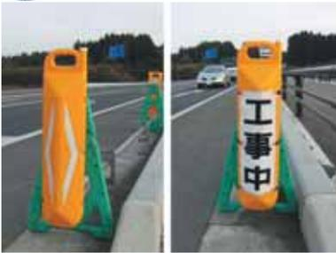
バリバンは、現道で使用している「単管バリケード」へ簡単に装着でき、反射材と製品色による“視線誘導効果”や、製品断面構造等による車両追突時の“衝撃緩衝効果”など、単管バリケードの機能性・安全性を向上させます。また、メッセージシートを活用すれば、補助的な看板の役割を果たし、一般ドライバーへ“注意喚起”も促せる、単管バリケード用視線誘導・保護カバーです。
