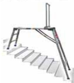
作業効率を向上させる広い天板。作業時の安全を確保する後部墜落ストッパー。狭い階段幅での作業性を配慮し、下段部は潜り抜けが可能で上段及び下段主脚は伸縮できるため、幅広い階段形態に対応可能となり折り畳むことでコンパクトになります。
