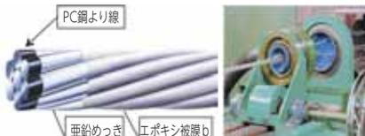
「Ducst」はPC鋼より線の全素線を亜鉛メッキとエポキシ樹脂被膜にて防錆した世界初の全素線二重防錆PC鋼より線。亜鉛メッキの犠牲防食効果とエポキシ樹脂被膜の腐食安定性の両者を組み合わせ、優れた耐久性を発揮・機械的性質はJIS-G3535に規定された規格を満足し各種基準に従った設計を行う事が可能。
