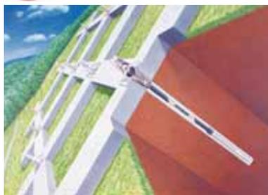
本技術はナット定着・摩擦圧縮型の永久（ランク A）グラウンドアンカー工法で、砂防・地すべり技術センターの技術審査証明において、頭部定着具の耐震性と緊張力調整機能が確認された唯一のアンカー工法である。そのため、将来の地震を考慮した対策や荷重変動に伴う有効な維持管理が可能となる。さらに、短納期可の工場製品なので、早期復旧が要求される工事において工期縮減や現場作業省力化に貢献できる。
