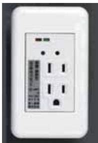
大規模地震対策では、建物の耐震性の確保は勿論ですが、重要なのは火災対策です。阪神淡路大震災では、各所で発生した火災が被害を拡大しました。その出火原因の6割が、地震による停電が解除され再送電された時に電気器具から発火する通電火災でした。出火防止コンセントは、大地震時の電気火災や日常の電気火災防止を目的に、地震感知センサーと温度センサーを内蔵し、震度5以上の地震を感知し、電源を即座に遮断し電気器具の破損、転倒による火災を未然に防止するコンセントです。また、再送電時の通電火災やほこり等のトラッキング火災を防止し、落雷時の誘導雷からパソコン機器等を保護し地震、配線火災を24時間監視します。
