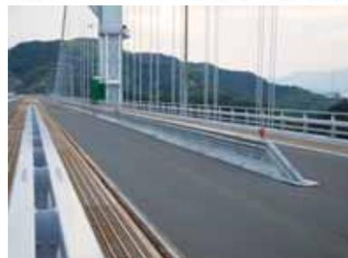
「ミニガードシステム」は、材質が亜鉛メッキスチール材で本体部エレメントとターミナル部(スタート、エンド)から構成された移動式防護柵(プレハブガードレール)です。本システムは次のような効果が挙げられます。①エレメント1体が軽量なので重機作業が不要。②機能的なデザインで安全性と美観性が向上 ③車両が衝突した場合にエレメントの曲線構造により脱輪・横転を防止し、衝突後の車両を正しい走行方向に誘導が可能。④曲線半径 R=80m 程度まで対応できる。⑤材料は全てリース材で産業廃棄物が発生しない。
