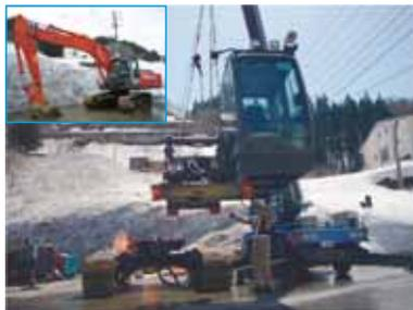
空輸対応型バックホウは、地震や降雨に伴う山間部における地滑り災害など、陸路による重機輸送が不可能な災害に対応するため、ヘリコプターによる空輸作業を迅速に行えるよう、最大分割重量の低減及び分解組立に要する時間の短縮を目的として開発されたものである。今回開発したバックホウは、これまで市場に存在した空輸対応型バックホウの最大規格（0.5m）の2倍のバケット容量（1.0m）を確保し、施工能力の大幅な改善を図ったものである。
