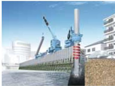
**障害物を貫通する先端ビット付き鋼管杭の回転切削圧入**
